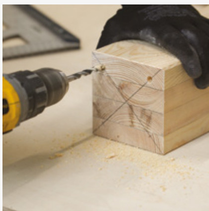
2 Bušenje otvora za vijke za drvo.
