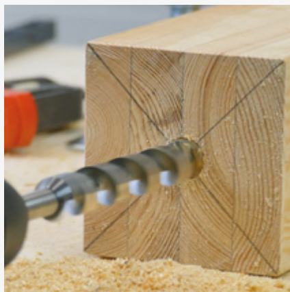
2 Bušenje otvora za šipku s navojem
