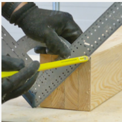
1 Određivanje dijagonala stupa.
